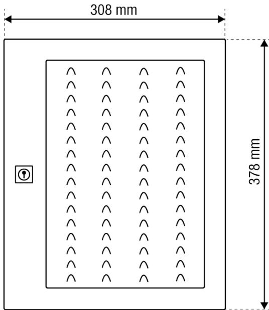
**1 format A4**, avec 32 porte – étiquettes, intérieur, mural, en tôle d'acier galvanisé, façade interchangeable en verre synthétique 3 mm avec renforts latéraux métalliques, fermeture par serrure en zamak, 2 clés fournies / Dimensions (l x h x p) 308 x 378 x 39 mm / Peinture polyester, 20 coloris disponibles et autres RAL en option.
