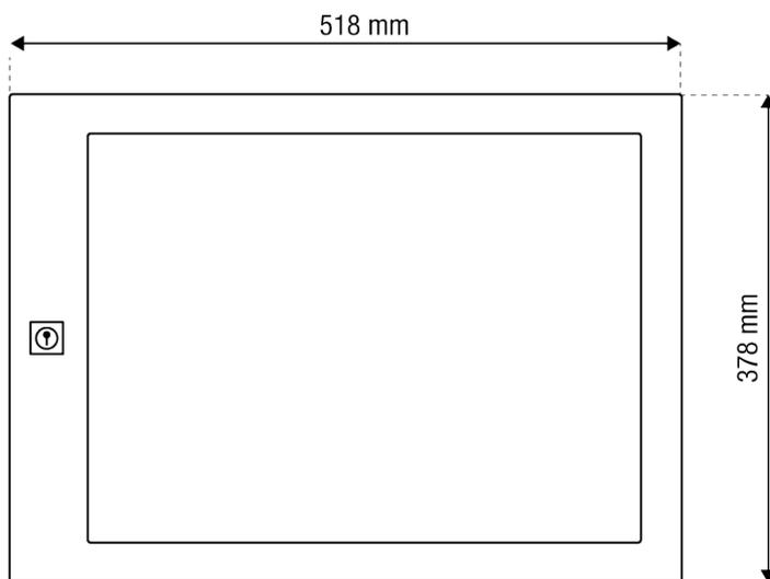
**2 formats A4**, intérieur, mural, en tôle d'acier galvanisé, façade interchangeable en verre synthétique 3 mm avec renforts latéraux métalliques, fermeture par serrure en zamak, 2 clés fournies / Dimensions (l x h x p) 518 x 378 x 39 mm / Peinture polyester, 20 coloris disponibles et autres RAL en option.
