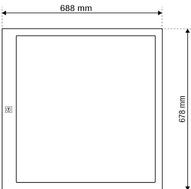
**6 formats A4**, intérieur, mural, en tôle d'acier galvanisé, façade interchangeable en verre synthétique 3 mm avec renforts latéraux métalliques, fermeture par serrure en zamak, 2 clés fournies / Dimensions (l x h x p) 688 x 678 x 39 mm / Peinture polyester, 20 coloris disponibles et autres RAL en option.
