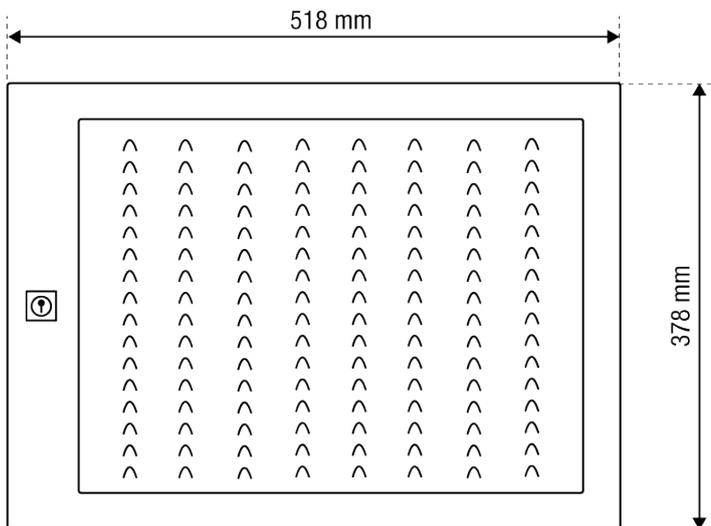
**2 formats A4**, avec 64 porte – étiquettes, intérieur, mural, en tôle d'acier galvanisé, façade interchangeable en verre synthétique 3 mm avec renforts latéraux métalliques, fermeture par serrure en zamak, 2 clés fournies / Dimensions (l x h x p) 518 x 378 x 39 mm / Peinture polyester, 20 coloris disponibles et autres RAL en option.
