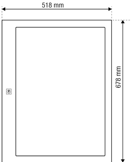
**4 formats A4**, intérieur, mural, en tôle d'acier galvanisé, façade interchangeable en verre synthétique 3 mm avec renforts latéraux métalliques, fermeture par serrure en zamak, 2 clés fournies / Dimensions (l x h x p) 518 x 678 x 39 mm / Peinture polyester, 20 coloris disponibles et autres RAL en option.
