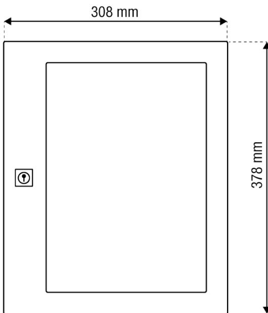
**1 format A4**, intérieur, mural, en tôle d'acier galvanisé, façade interchangeable en verre synthétique 3 mm avec renforts latéraux métalliques, fermeture par serrure en zamak, 2 clés fournies / Dimensions (l x h x p) 308 x 378 x 39 mm / Peinture polyester, 20 coloris disponibles et autres RAL en option.
